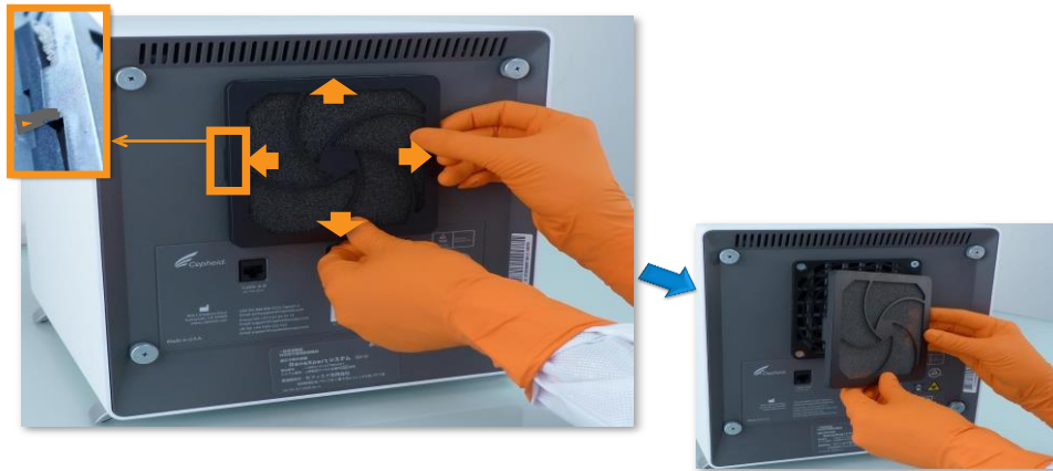
Gambar 6.7 Cara melepas bagian penutup belakang dan filter debu kipas (filter debu diluar alat)
