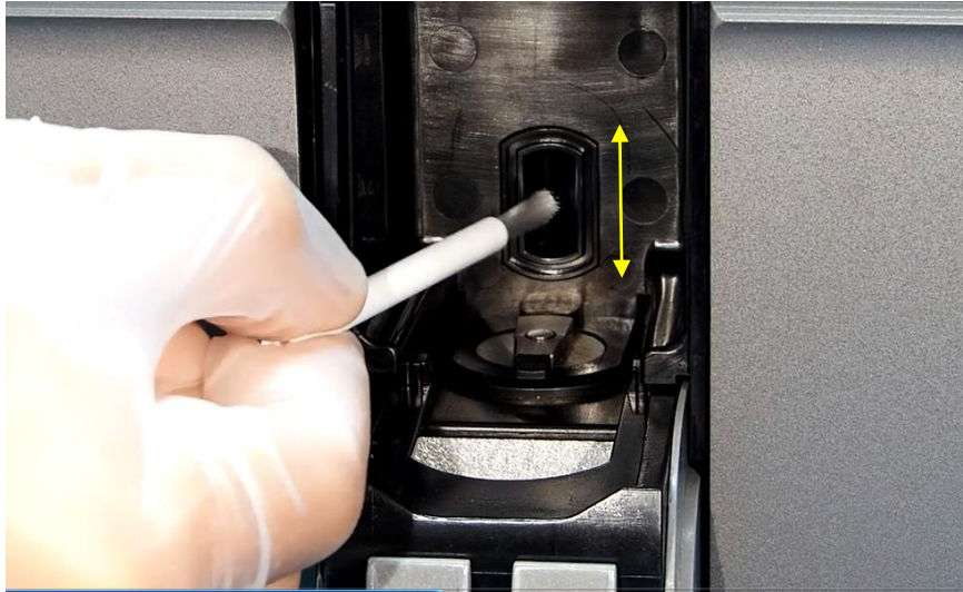
Gambar 6.16 Cara menyikat slot I-core dengan sikat I-core
